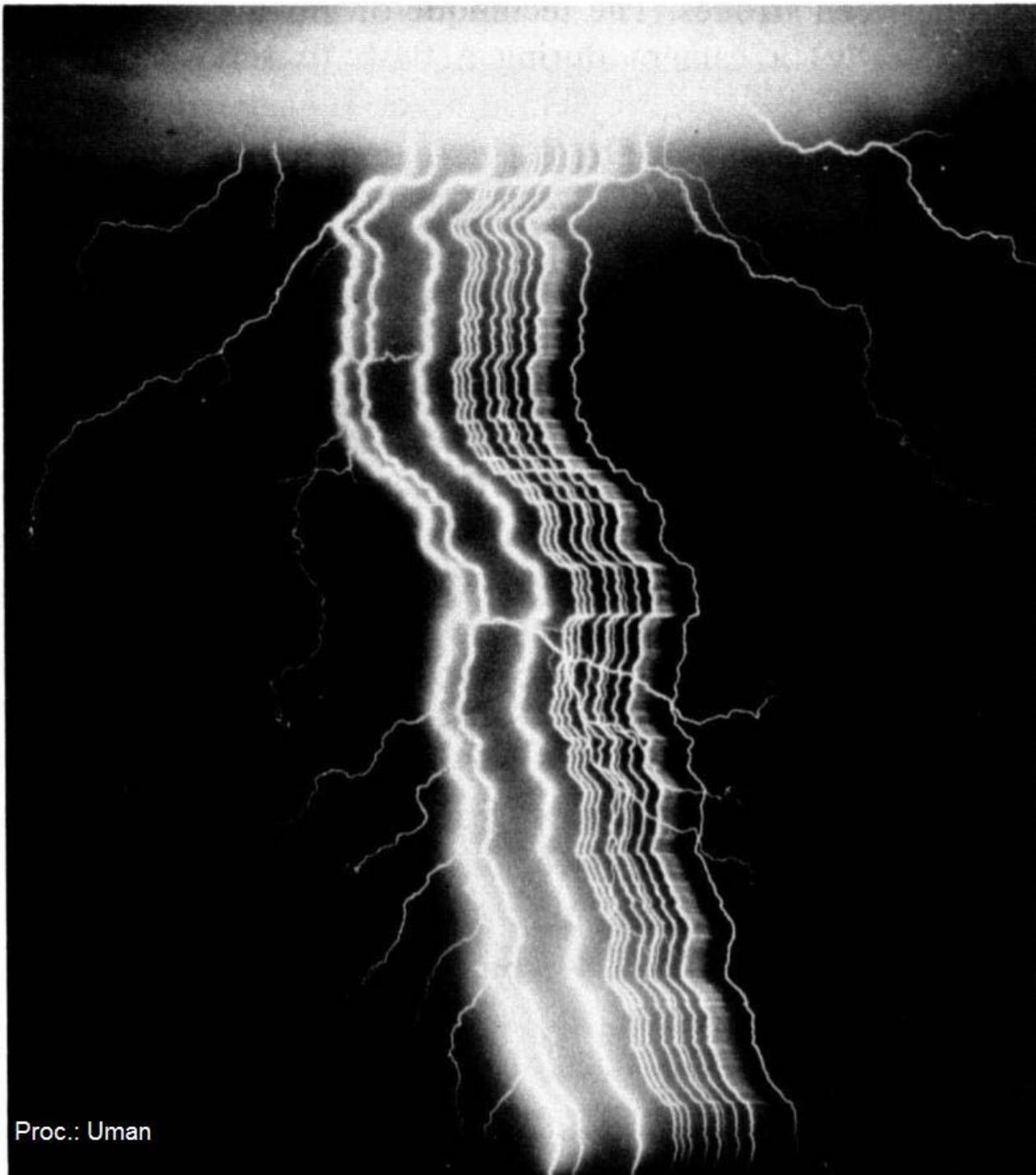
**Fotografía tomada con una cámara streak de un rayo con 12 descargas. La ordenada del tiempo va hacia la derecha. Notar la corriente continua en el stroke número 11.**
