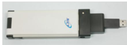
Figura 5.16: Prototipo de USB-stick IEEE 802.11af [37].
