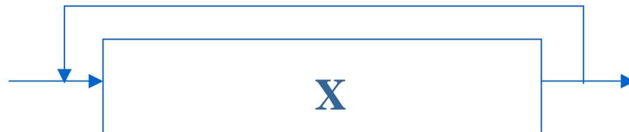
El reciclo en el RTFP produce una disminución de la concentración en la entrada por lo que el perfil de concentración a lo largo del reactor varía menos. Si la recirculación es muy grande, el perfil es casi constante y desde ese punto de vista se asemeja al RCAI, no desde el punto de vista hidráulico, sino desde el punto de vista de la concentración.
