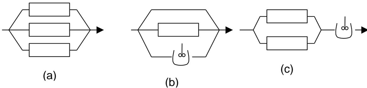
8. El siguiente modelo compuesto representa el comportamiento de un reactor real:
