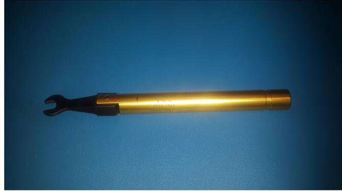
Figura 4.4: Torquímetro del kit de calibración 85033E
