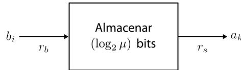
La relación entre las tasas de transferencia de bits  $r_b$  y de símbolos  $r_s$  se obtiene a través del análisis de los tiempos de bits y de símbolo. Para generar un símbolo  $a_k$  es necesario observar  $\log_2 \mu$  bits por lo que la duración del símbolo es
