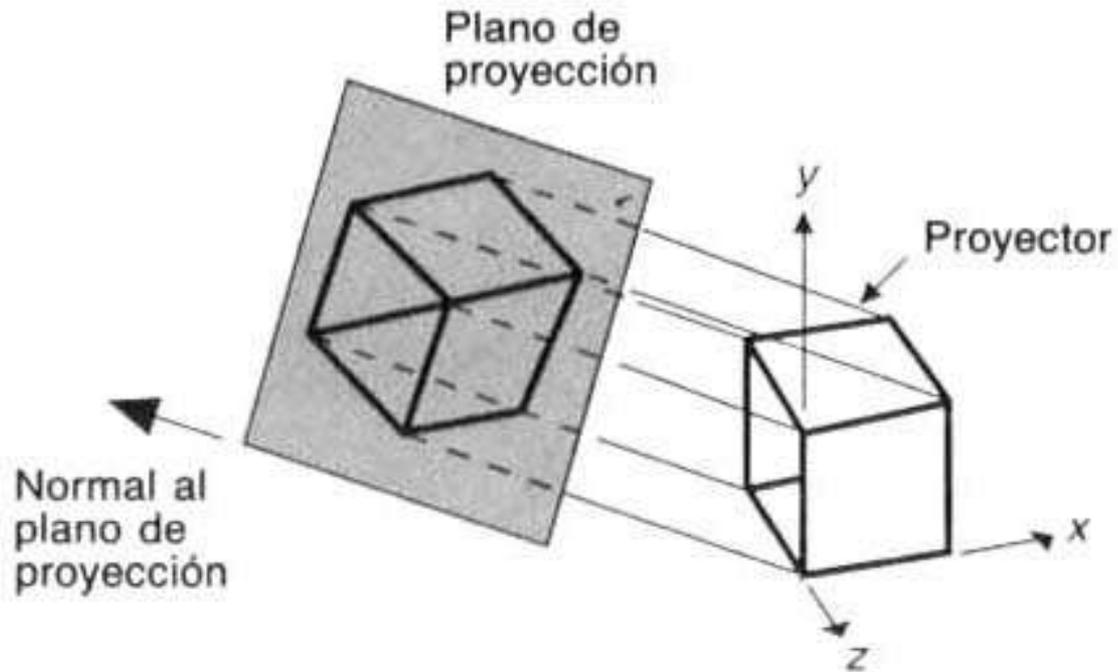
Construcción de una proyección isométrica de un cubo unidad. ( Adaptado de [CARL78], Association of Computing Machinery. Inc)
