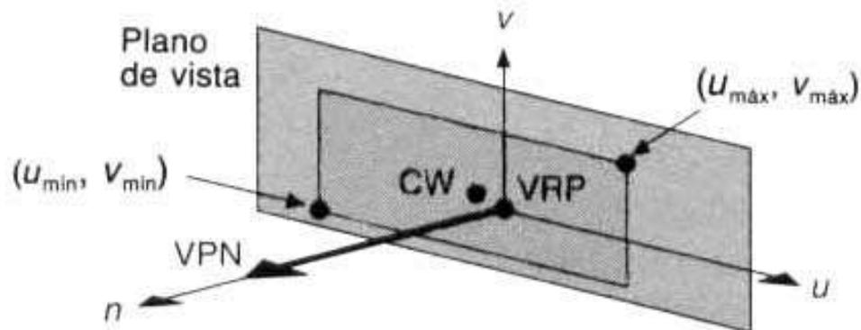
El sistema de coordenadas de referencia de visualización (VRC) es un sistema de mano derecha formado por los ejes  $u$ ,  $v$  y  $n$ . El eje  $n$  siempre es VP.  $CW$  es el centro de la ventana.
