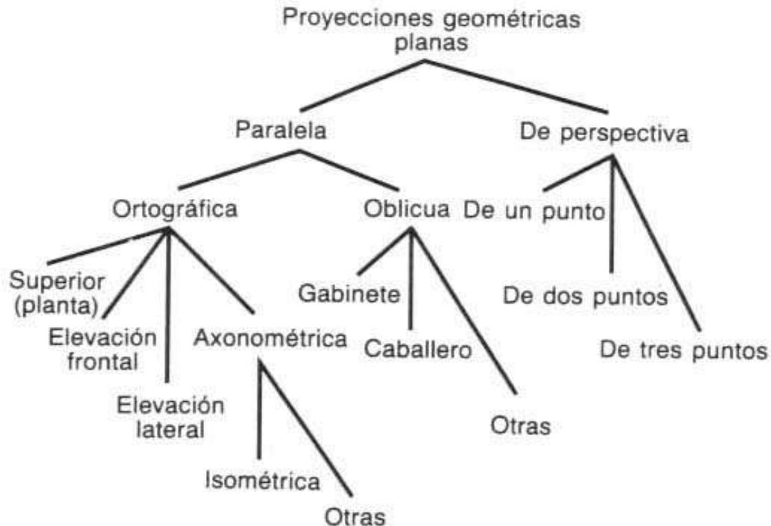
Subclases de las proyecciones geométricas planas. La **vista de planta** es otro término para la vista superior. Las vistas **frontal** y **lateral** muchas veces se emplean sin el término **elevación**.
