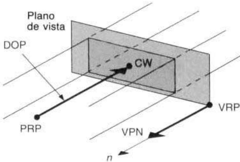
Volumen de vista de paralelepípedo infinito para una proyección paralela ortográfica. VPN y la dirección de proyección (DOP) son paralelas. DOP es el vector de PRP a CW y es paralelo a VPN.
