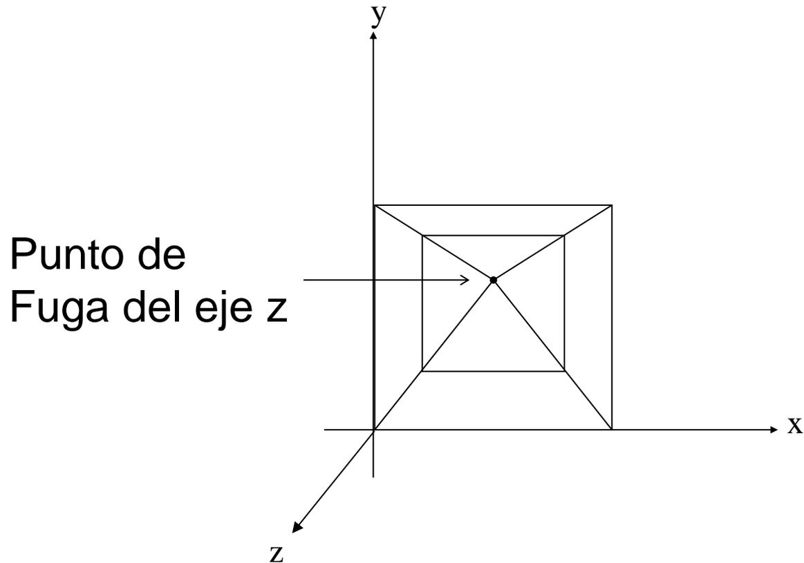
Vista frontal de la Proyección Perspectiva de un cubo en un plano, cortando el eje z con el punto de fuga de las líneas perpendiculares al plano de proyección
