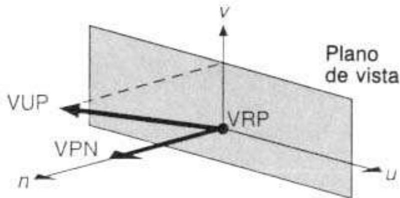
El plano de vista está definido por VPN y VRP; el eje  $v$  se define con la proyección de VUP a lo largo de VPN sobre el plano de vista. El eje  $u$  forma el sistema VRC de mano derecha con VPN y  $v$ .
