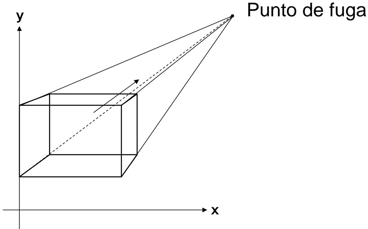
Proyección Perspectiva de un cubo en un plano, cortando el eje  $z$  con el punto de fuga de las líneas perpendiculares al plano de proyección
