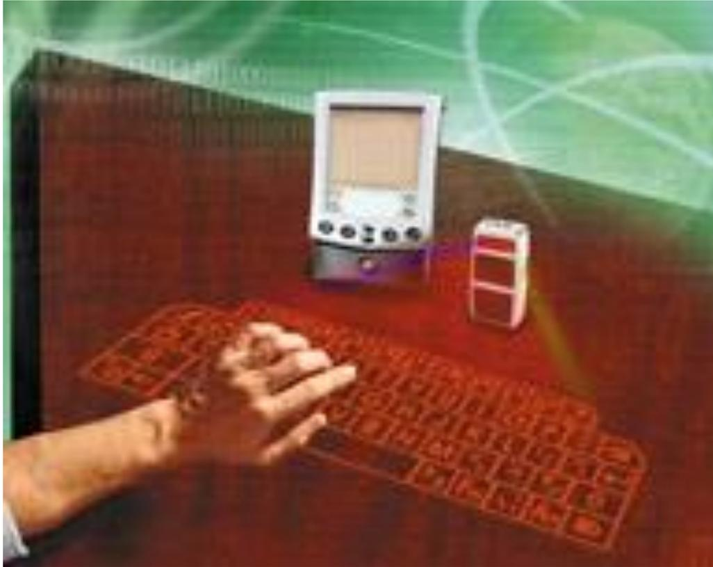
Se emite un láser que incide en una superficie lisa, proyectando un teclado. El usuario “presiona” las teclas, escribiendo en el PDA.
