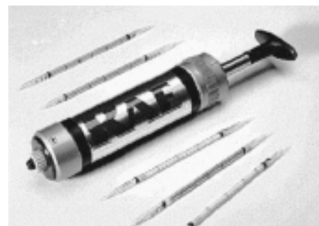
Figura 5-13: DETECTOR COLRIMÉTRICO RAE CON TUBOS COLRIMÉTRICOS
