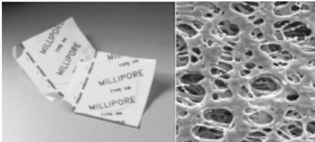
Figura 5-19: FILTRO DE ACETATO DE CELULOSA “MILLIPORE” VISTO AL MICROSCOPIO
