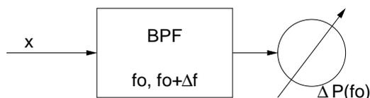
La señal  $x$  se hace pasar por un pasabandas ideal con frecuencias de corte  $f_0$  y  $f_0 + \Delta f$ . A la salida del pasabajos, hay un medidor de
