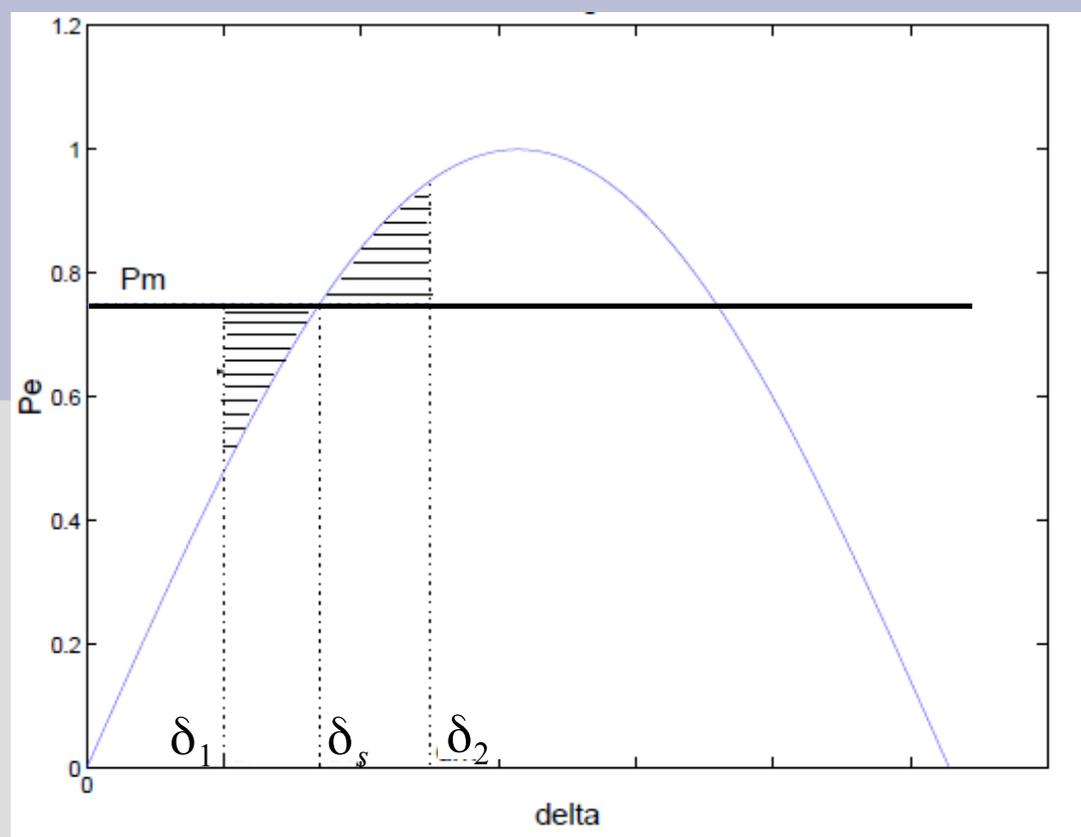
Así, el área bajo la curva de transferencia de potencia es siempre igual al incremento de energía cinética entre los puntos P1 y P2
