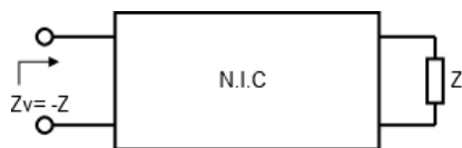
Figura 4.1: Conversor de impedancia negativa
