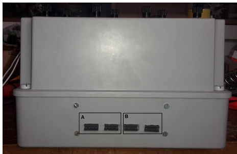
Figura B7: Vista lateral derecha del equipo, se observan los puertos correspondientes a la comunicación con el sensor de temperatura (A) y los encoder para relevar la velocidad de las máquinas (B).
