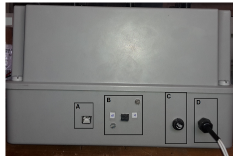
Figura B8: Vista lateral izquierda, se observa el puerto USB (A) y el RS485 (B) correspondientes a la comunicación con la PC y el CVMk2 respectivamente. También se encuentra la entrada de alimentación de equipo (D) junto con el fusible de protección (C).
