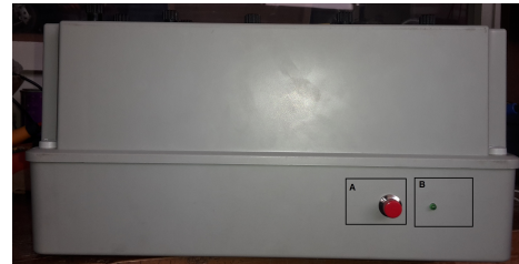
Figura B6: Vista lateral superior del equipo donde se observa el botón de encendido (A) y el led indicador de encendido del equipo (B).
