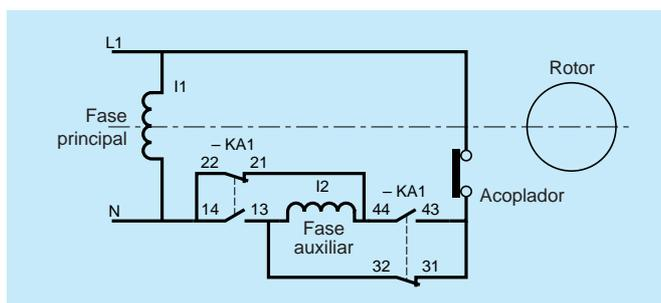
Dispositivo de inversión de conexiones de la fase auxiliar
