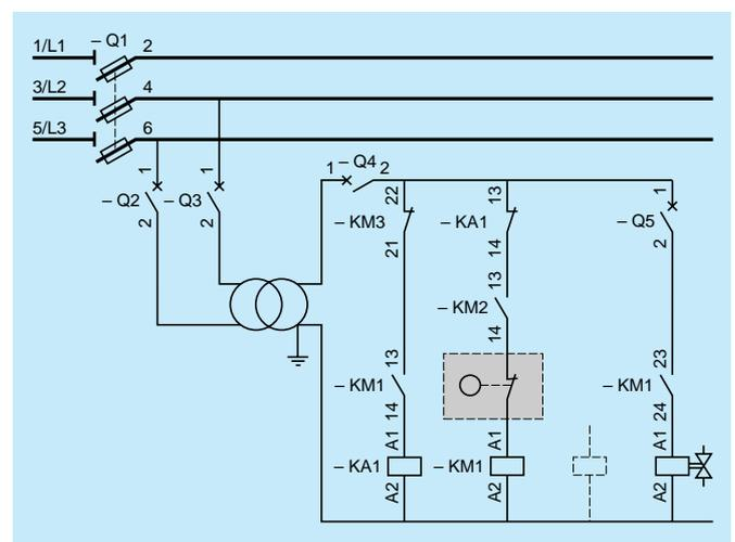
Esquema con disyuntores de control magnetotérmicos
