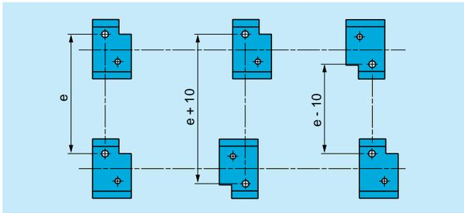
Principio de ajuste del entreje con tuercas 1/4 de vuelta
