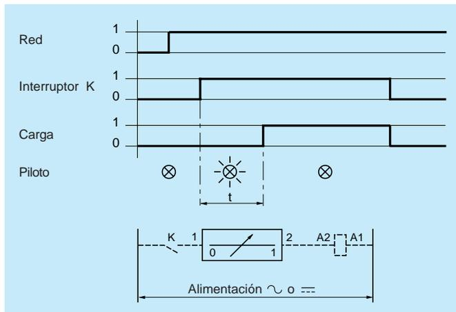
Diagrama secuencial y conexión de un temporizador de trabajo
