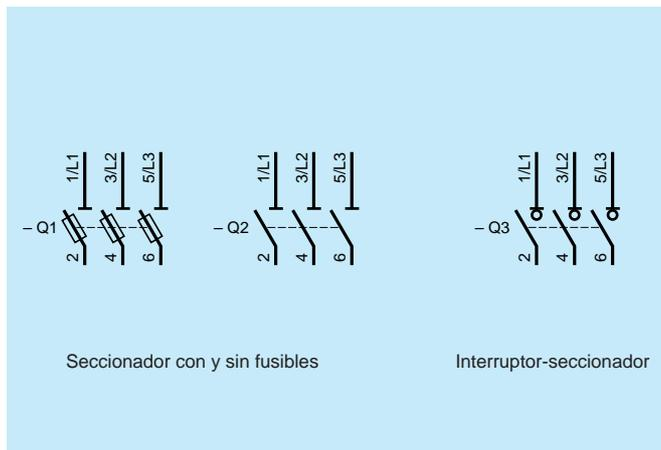
Símbolos de los seccionadores y de los interruptores seccionadores
