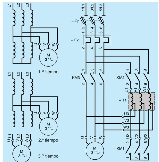
Arranque por autotransformador
