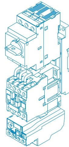
Entre los receptores más utilizados para el accionamiento de máquinas se encuentran los motores eléctricos asíncronos de jaula. Los equipos de control de potencia destinados a controlarlos, normalmente llamados arrancadores, realizan las funciones de seccionamiento, protección y conmutación. Se pueden clasificar en tres familias:
