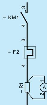
Amperímetro en transformador de corriente
