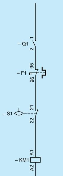
Control automático o manual, mediante conmutador "auto-parada-man"
