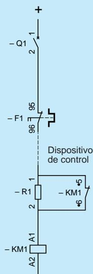
Corriente rectificada con rectificador incorporado al contactor
