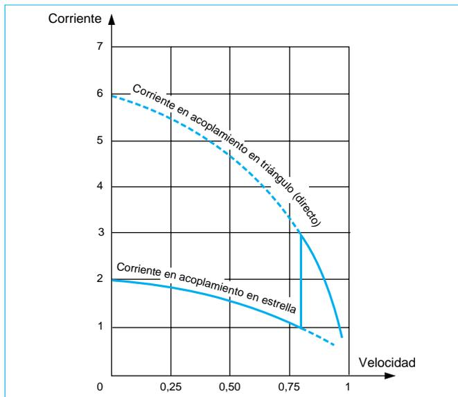
Curva de corriente/velocidad del arranque estrella-triángulo
