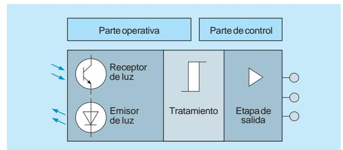
Composición de un detector fotoeléctrico
