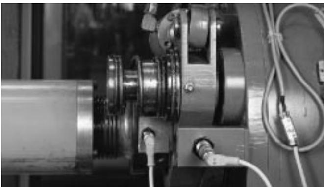
*Detectores XS de Telemecanique con conector*
