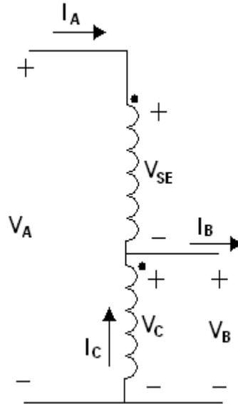
La principal desventaja del autotransformador que inmediatamente surge de la conexión planteada es que no dispone de aislación galvánica entre los bobinados primarios y secundarios, por lo que una elevación de potencial en un bobinado respecto a un punto repercute directamente en el otro. Por otra parte un cortocircuito en el bobinado “serie” aplica gran parte –o la totalidad en caso de un cortocircuito franco- de la tensión aplicada de un lado en el otro lado del transformador.
