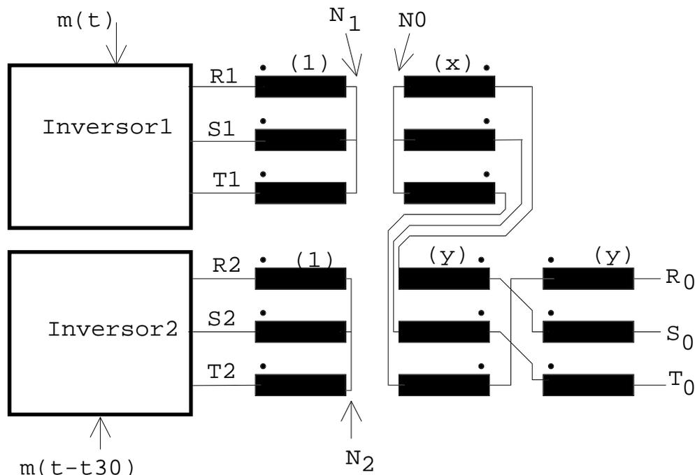
Las relaciones de espiras de los bobinados de los transformadores se colocaron entre paréntesis. Así el trafo alimentado por el Inversor1 tiene  $(x)$  espiras en el secundario por cada  $(1)$  espira del primario. El trafo alimentador por el
