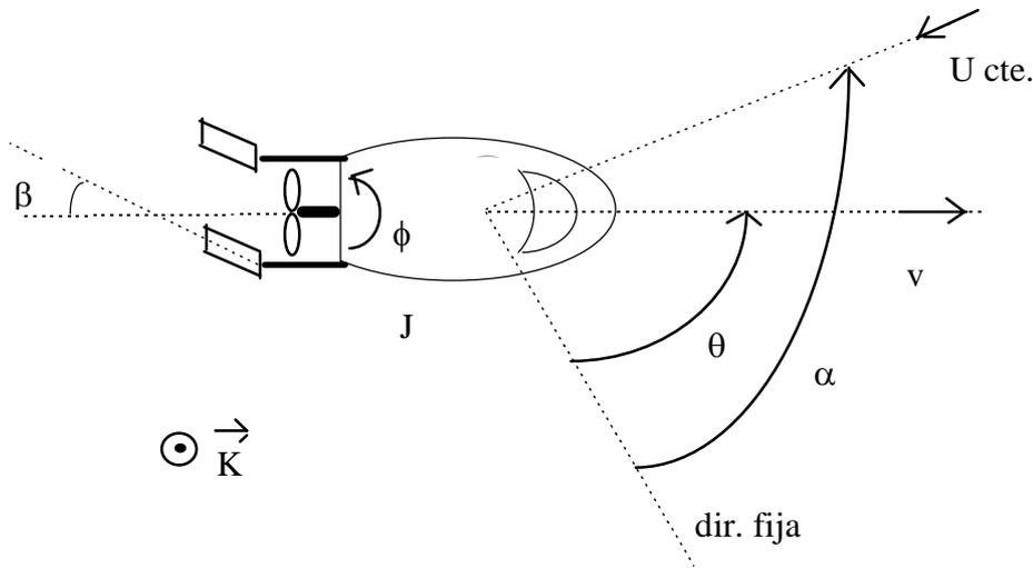
En un minisubmarino se controla la dirección de desplazamiento mediante un par de aletas que desvían el flujo generado por la hélice propulsora generando, por acción y reacción, un momento  $C\dot{\phi} \text{sen}(\beta)\bar{K}$ . ( $\bar{K}$  saliente del plano del dibujo).
