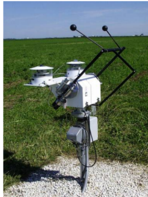
sistema redundante de medidas de alta calidad: piranómetros con puntos de sombra y mecanismo de seguimiento + pirheliómetros
