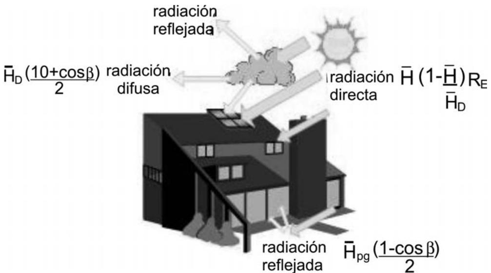
Fig. 4.20 Componentes de la radiación solar. Fuente ADEME 2000
