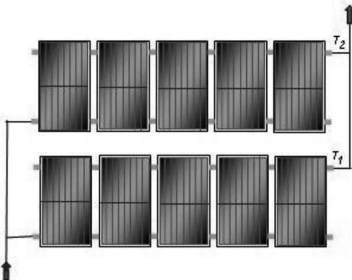
Figura 7.13 - Asociación en paralelo de dos baterías de 5 colectores solares
