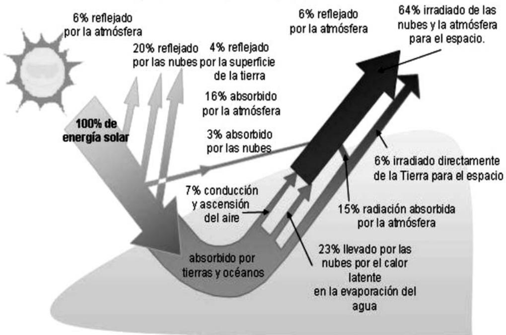
Figura 1.5 – Radiación solar global y sus componentes
