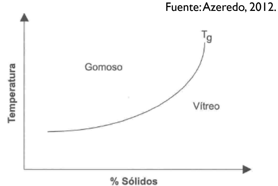
Figura 1. Representação da transição vítrea de um material amorfo.
