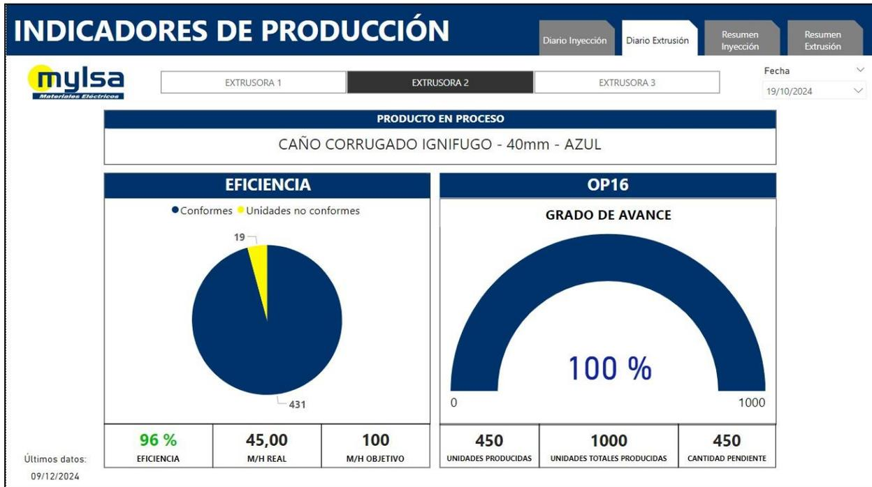
Figura 13 Perspectiva Operativa del Tablero de Indicadores - Extrusión
