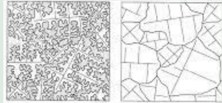
Crecimiento dendrítico: Ocurre cuando el calor latente de fusión es extraído por conducción a través del líquido subenfriado, aumentando la temperatura de este último a la temperatura de solidificación. La temperatura del líquido en la interfaz sólido - líquido es menor que la temperatura de solidificación.
