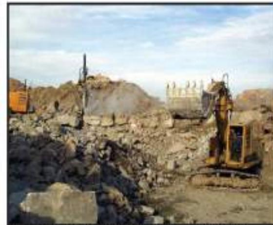
Foto 19: Línea de barrenos para voladura.
