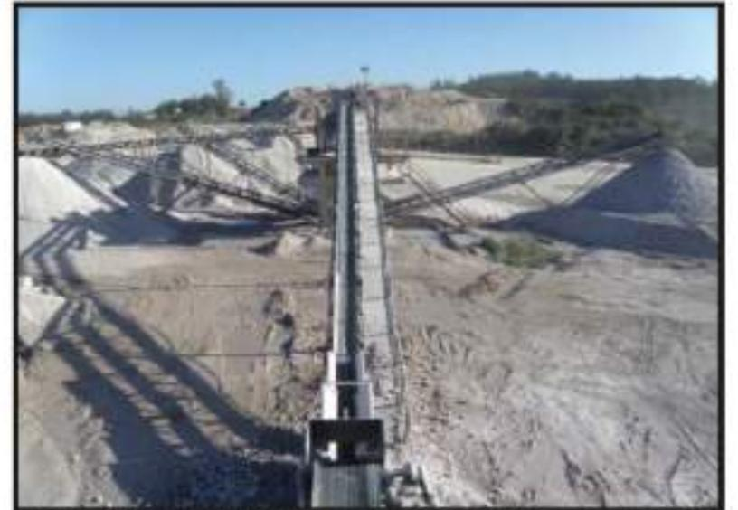
Foto 117: Trituración y clasificación granulométrica
