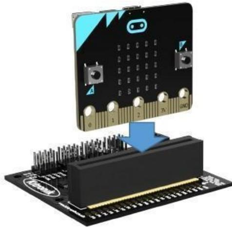
**Figura 5:** Conexión Micro Bit-Servo Driver
