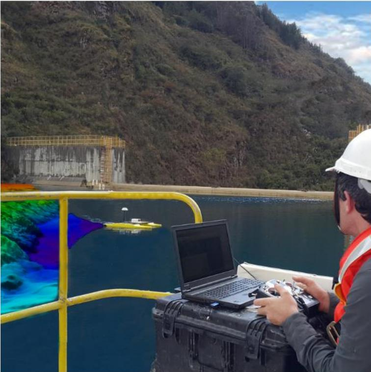
*La batimetría tiene como resultado, al igual que los levantamientos topográficos convencionales, un registro de coordenadas que representan al fondo del cuerpo de agua en estudio.*
