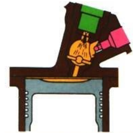
con antecámara o cámara de preencendido (Mercedes-Benz)
