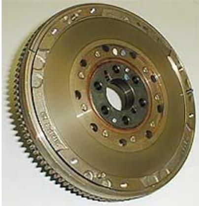
El volante motor o volante de inercia es el encargado de mantener al motor estable en el momento que no se acelera.
