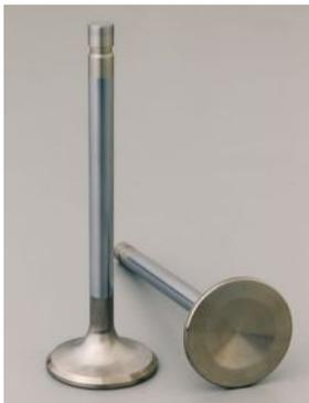
Las válvulas van ubicadas en la cámara de combustión y son los elementos encargados de abrir y cerrar los conductos por donde entra la mezcla (válvulas de admisión) y por donde salen los gases de escape (válvulas de escape).
