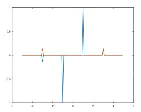
A través de la transformada podemos averiguar que la función es de la forma  $f(x) = \sin(2\pi x) + 0.2\sin(6\pi x + \pi/2)$  (nos muestra cuáles son las frecuencias que aparecen en la señal, sus respectivas amplitudes y sus fases).
