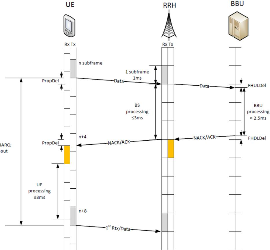
Limite de 8ms en recepción del HARQ lleva a una limitante en el delay entre RRH y BBU.
