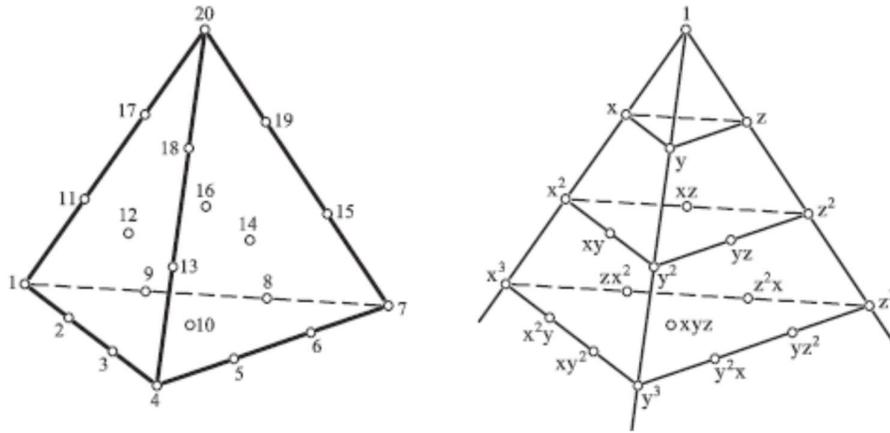
Figura 10.3 Tetraedros linear 4 nodos, cuadrático (10 nodos) y cubico (20). términos polinomiales contenidos en la función de interpolación. (Oñate 2009).
