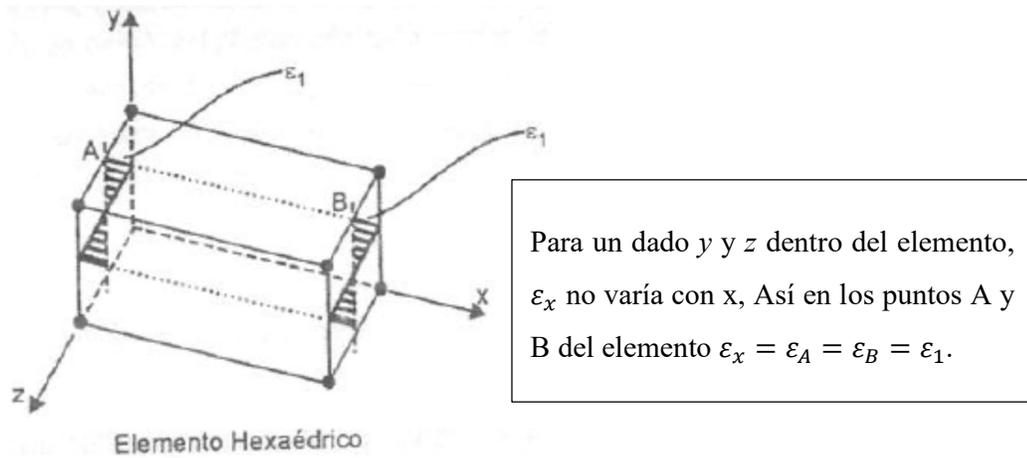
Figura 10.7 Calculo de las deformaciones en la dirección  $\varepsilon_x$  para el elemento sólido hexaédrico lineal. (Alves 2018).
