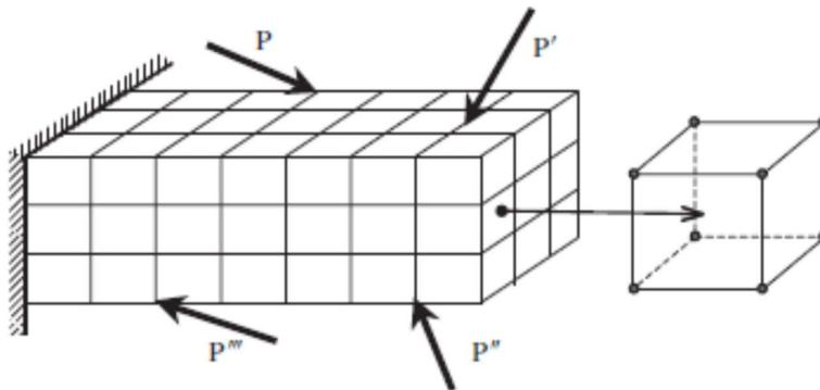
Figura 10.4 Bloque solido dividido en elementos solidos hexaedro de 8 nodos. (G.R.Liu)
