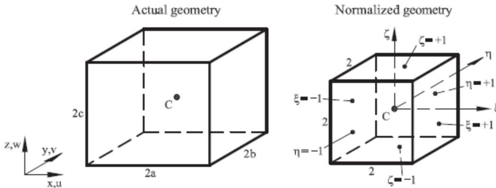
Figura 10.5 Elemento sólido hexaedro en el estado actual y mapeado a una geometría normalizada. (Oñate 2009).
