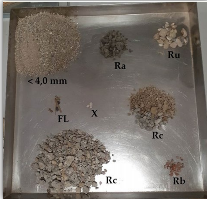
Residuos de hormigón
