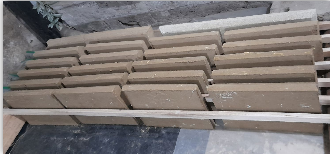
Bloques de tierra comprimida
