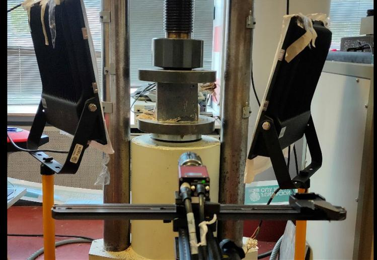
**PROBETA CÚBICA DE HORMIGÓN
