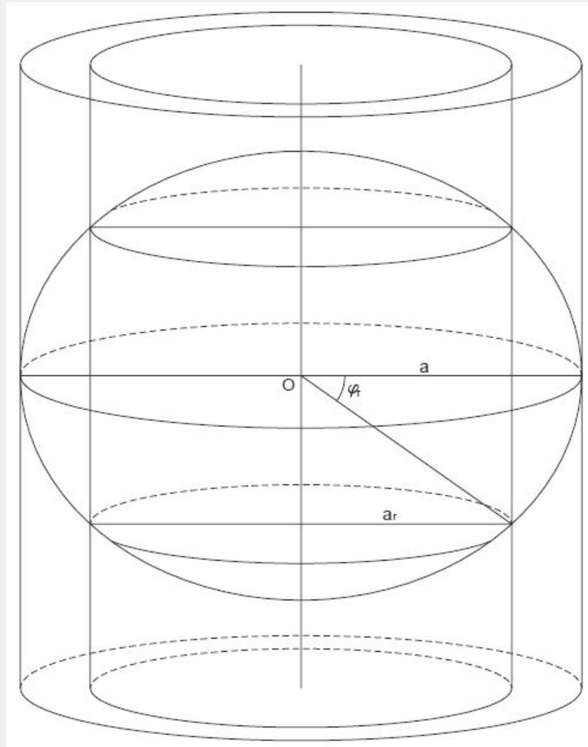
Entonces, este procedimiento implica sólo una reducción de escala y todas las conclusiones a las que llegamos para el cilindro tangente en  $\varphi_0$ , son válidas para el cilindro secante en  $\varphi_r$ .
