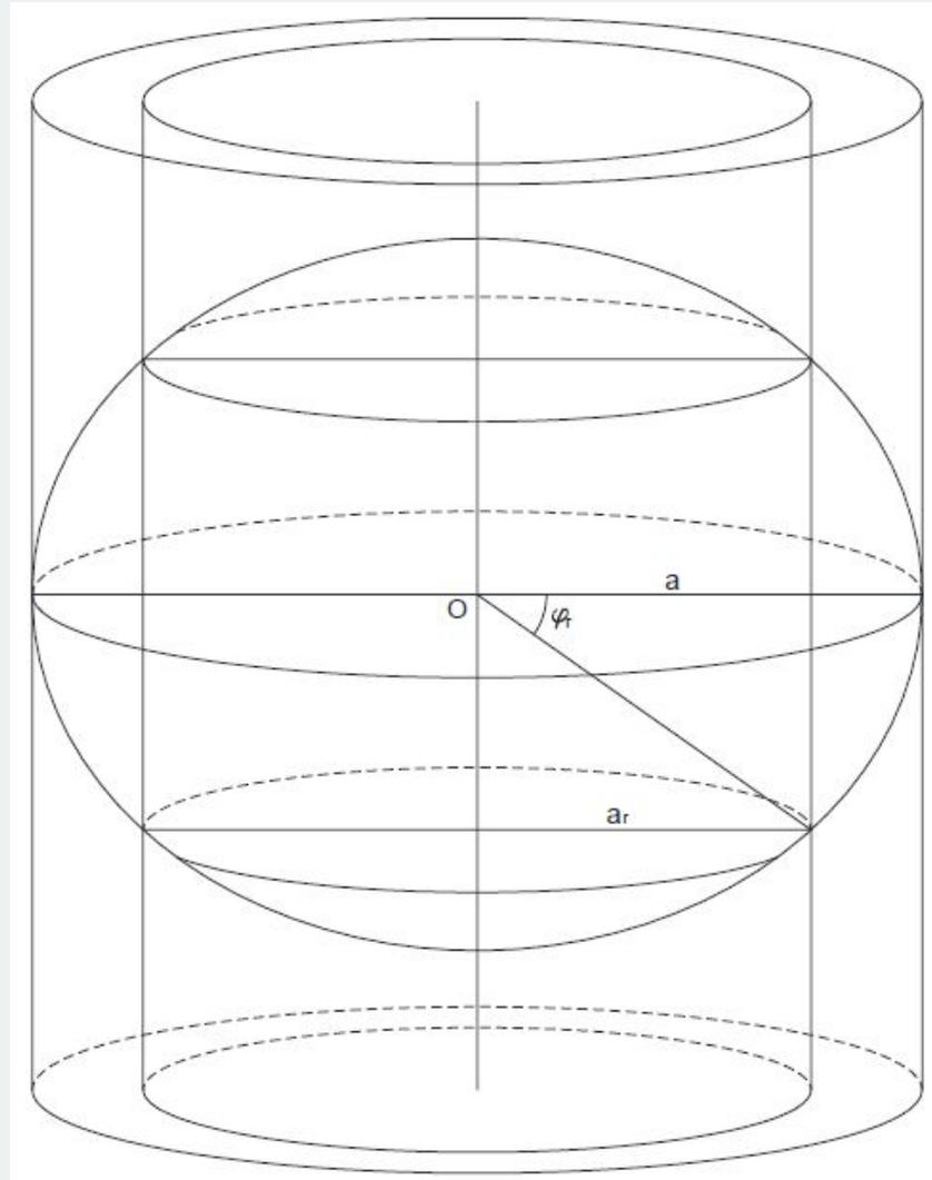
Así, pasamos de considerar una proyección sobre un cilindro de radio  $a$  correspondiente al Ecuador ( $\varphi = 0^\circ$ ), a uno de radio  $a_r$ , correspondiente al paralelo de la latitud de referencia  $\varphi_r$ .
