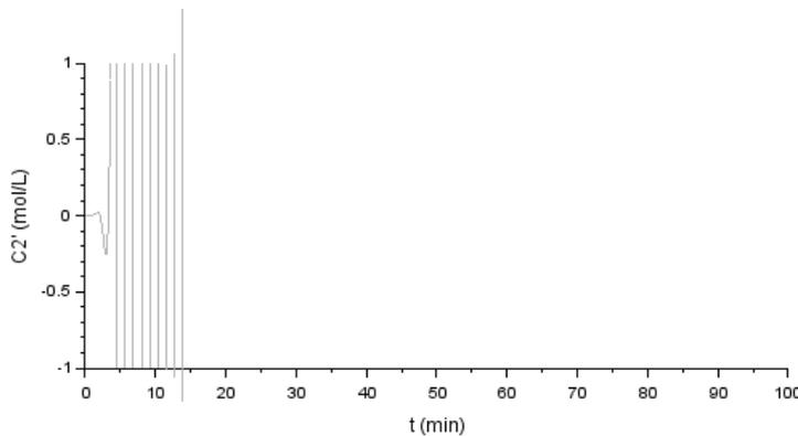
El controlador no está bien sintonizado, la constante de tiempo es muy chica y desestabiliza el bucle. Por ejemplo con una constante de tiempo  $\tau_i = 70$  min el resultado sería
