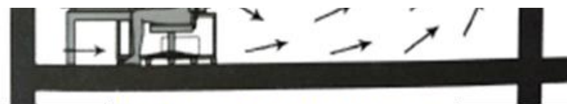
Ventilazione a miscelazione
