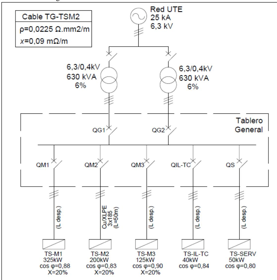
Los tableros TS-M1, TS-M2 y el TS-M3 son tableros de motores, el tablero TS-IL-TC es de iluminación y tomas y el TS-SERV es de servicios. La corriente admisible ( $I_z$ ) por el cable entre el Tablero General y el tablero TS-M2 es de 437 A.
