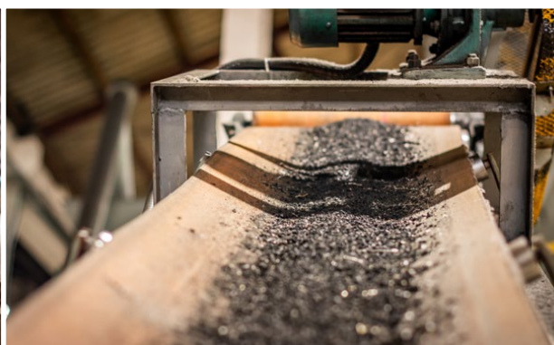
Ilustración 5. Plan CECONEU. Planta de trituración, granulado de caucho. Foto cortesía CECONEU.
