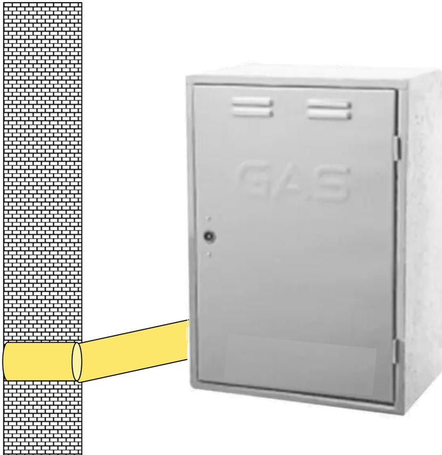
Quando el gabinete se ubique en un lugar cerrado, el mismo debe ventilar al exterior, mediante un ducto cuya sección mínima debe ser igual a 1,5 veces el diámetro de la cañería de entrada al gabinete, siendo el diámetro mínimo de 38 mm.
