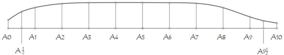
Fig. 6 - Flotación con semimangas intermedias
