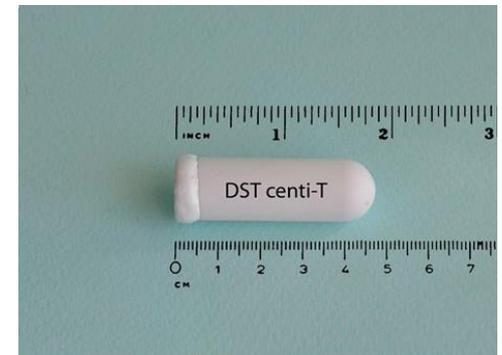
Ejemplos de sensores de temperatura con almacenamiento interno para mediciones *in situ*.
