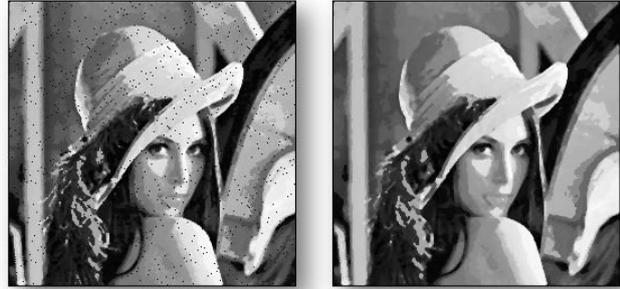
El filtro mediana (*median filter*) consiste en sustituir el valor de brillo de cada pixel por la mediana de los valores dentro de la ventana de pixels vecinos. Este filtro se caracteriza por ser efectivo en la eliminación de artefactos de ruido de un solo pixel, causando solo una pequeña reducción en la nitidez de la imagen [1].
