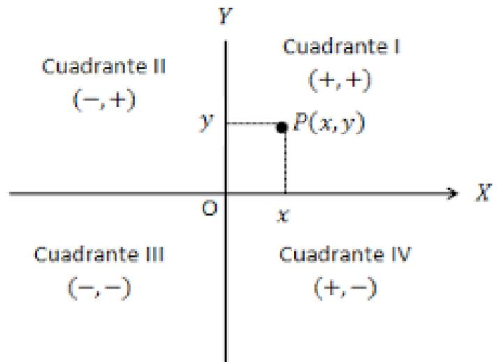
Para el caso de coordenadas cartesianas en el marco de la Topografía, el sentido positivo de la rotación es el sentido horario, el origen angular coincide con la dirección NORTE y los cuadrantes son los representados en la figura adjunta.
