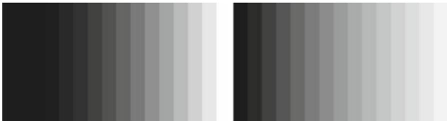
**Figura:** Gradiente de brillo sin aplicar corrección gamma (izquierda) y aplicando corrección gamma (derecha).
