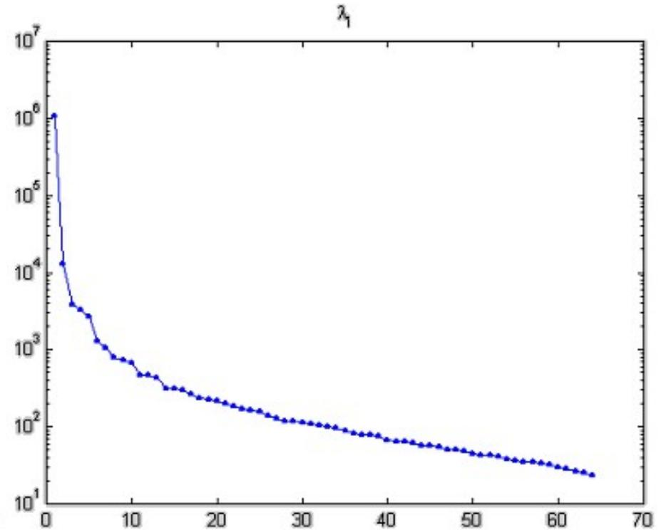
Izquierda: Disminución del error de proyección al ir agregando componentes.
