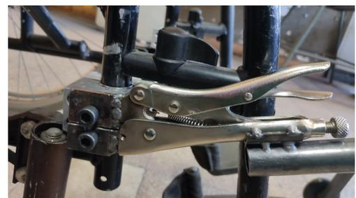
goma para amortiguar y que no choquen ambas piezas constantemente con el andar. Para las pinzas, se compraron pinzas comunes en una ferretería y se le modificó la cabeza para que encastré con los tornillos de los acoples gemelos.
