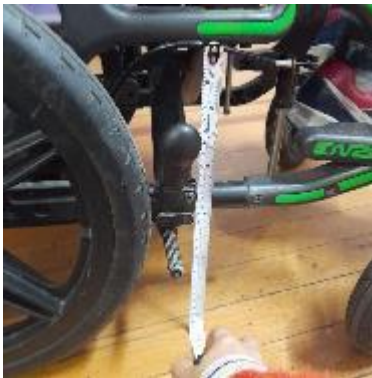
Figura 3: Distancia de Tubo verde al piso de 29 cm
