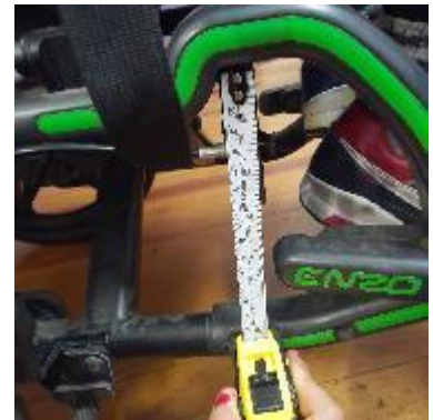
Figura 4: Distancia entre tubos de 15 y 15 cm
