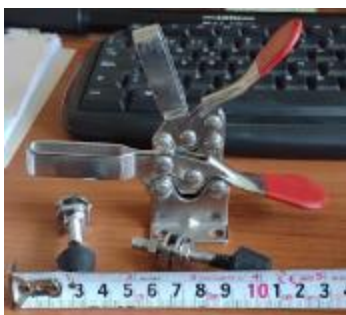
Figura 11: Brazos con cierres rápidos tipo cuchara
