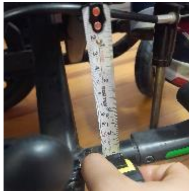
Figura 4: Distancia entre tubos de 15 y 15 cm
