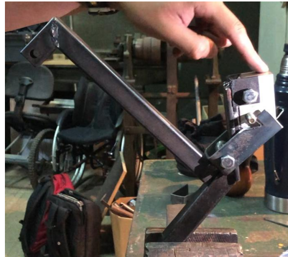
Horquilla y acople enganchados
