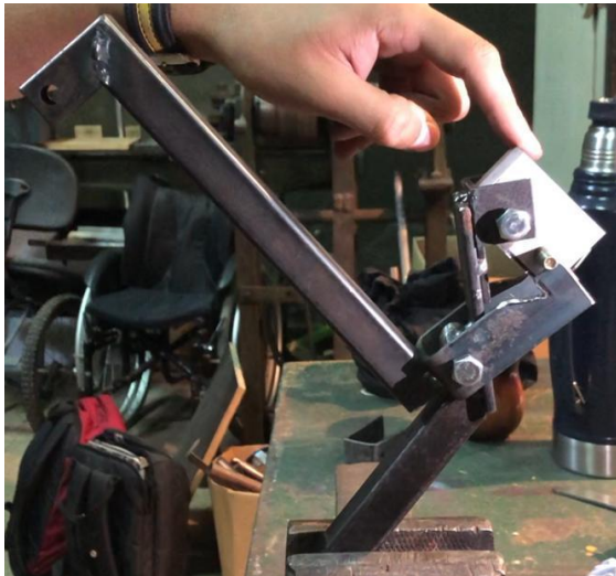
Horquilla separada de acople
