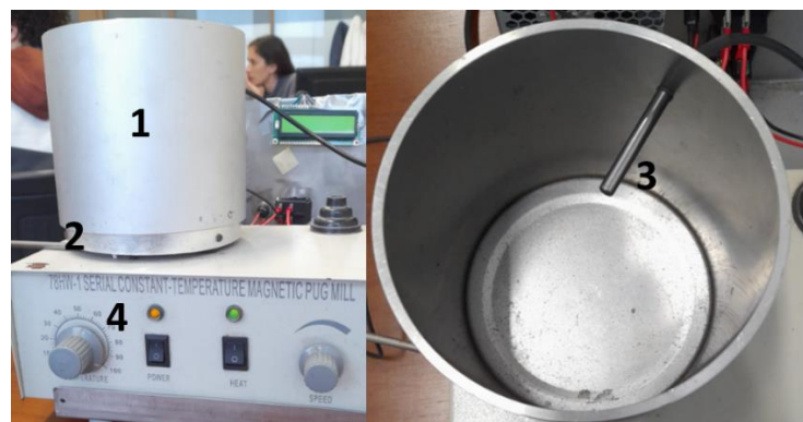
Figura 7.2 Foto de la planta construida para el laboratorio. 1 Columna de aluminio, 2 base termostaticada, 3 sensor de temperatura, 4 control externo de temperatura de la base.
