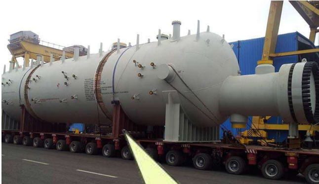
Intercambiador de calor para el reciclo de la síntesis de amoníaco
