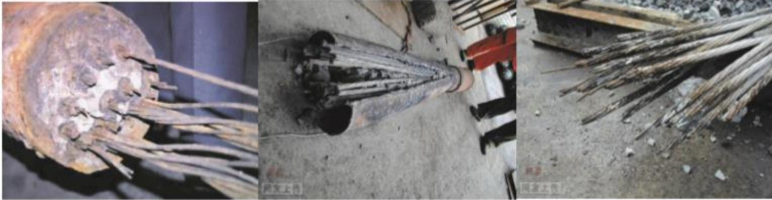
Por la fractura del cable, se encontró que la corrosión del cable era realmente severa. Los diferentes colores del cable demostraron que algunos de ellos se rompieron antes del colapso. Por lo tanto, todos los demás tirantes tuvieron que ser reemplazados. En sustitución se eligieron los nuevos tirantes anticorrosión con protección PE.
